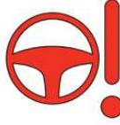
, qui signale qu'il faut initialiser la direction, restera allumé ; par conséquent, dans les 30 secondes suivant le démarrage, tourner le volant d'une extrémité à l'autre, puis le reporter en position centrale.
