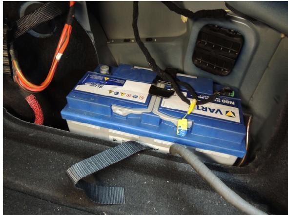
Poussez la batterie à fond à Gauche et monter la patte de fixation basse à droite
