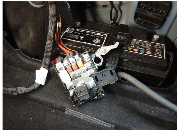
Ouvrir la courroie de retenue de la batterie.
