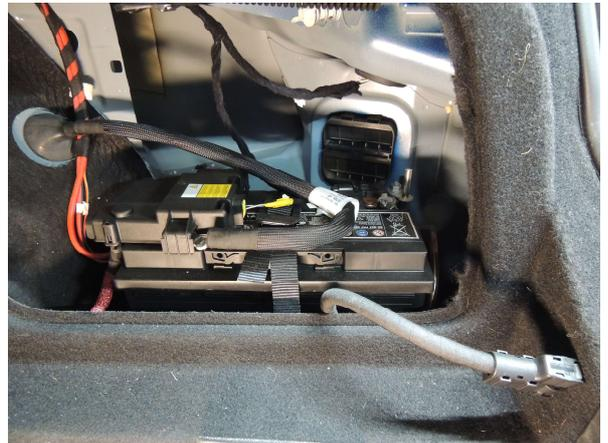
Desserrer l'écrou (clé de 10) et débrancher la borne et le capteur de niveau de charge du pôle négatif de la batterie.
